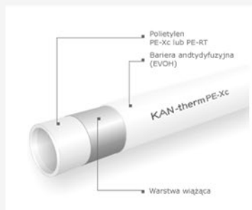
Konstrukcja rur PE-RT lub PE-Xc KAN-therm
